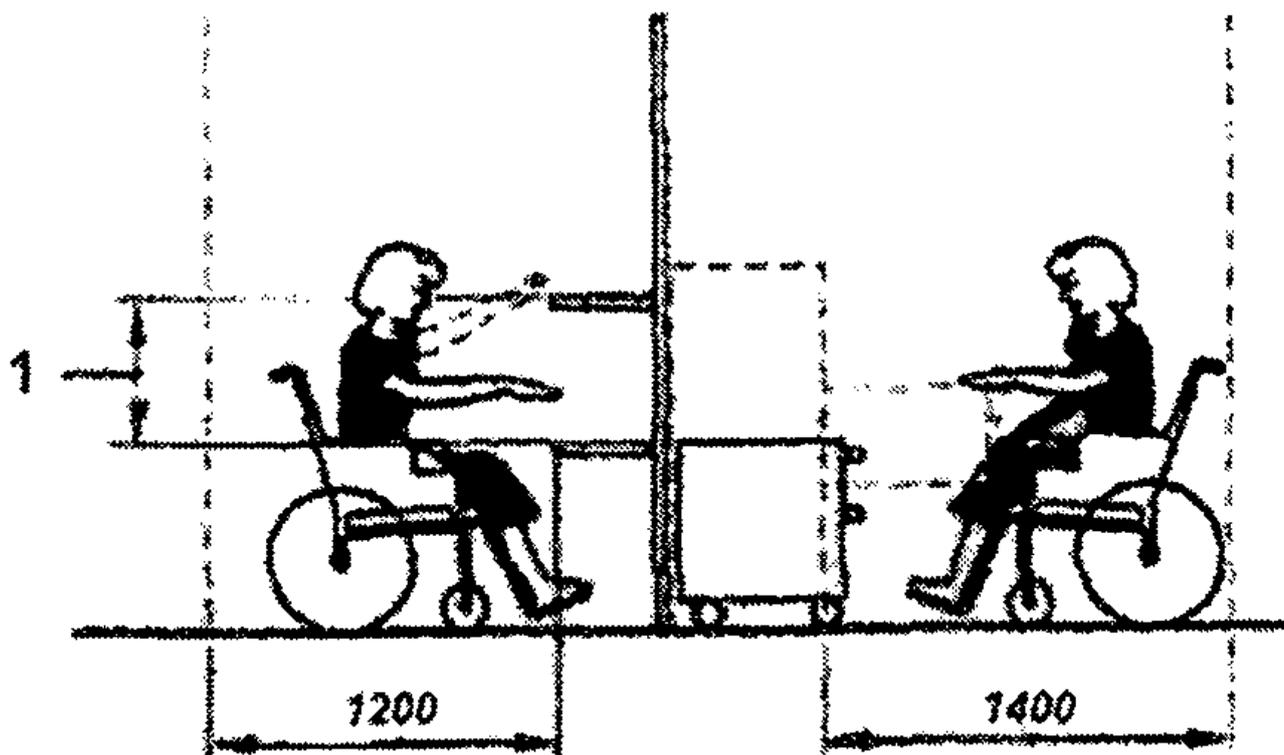
1 - удобная зона досягаемости; 650 мм от уровня пола до нижней полки и 1000 мм до верхней полки
