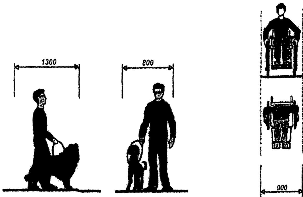
Рисунок Д.3. Оптимальные габариты полосы движения
