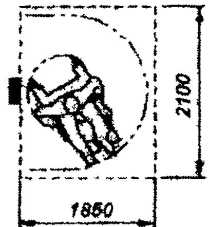
Рисунок Д.12. Кассы, телефоны-автоматы, платежные терминалы
